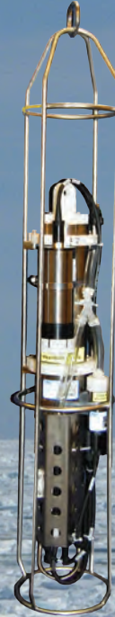
SBE 19plus V2 SEACAT CTD in Ice Cage
